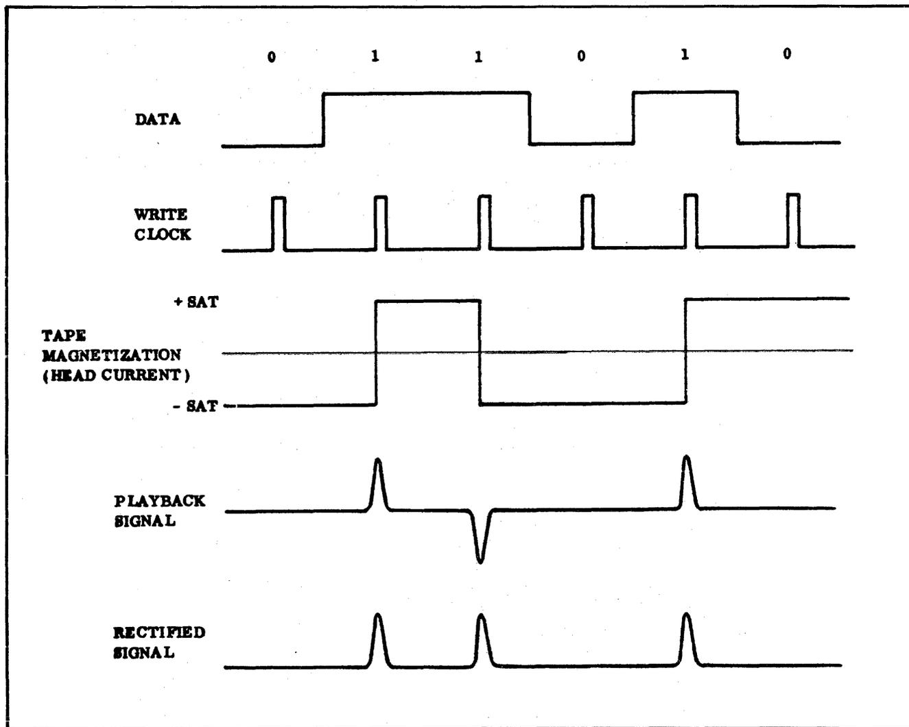
**Figure 1-2. NRZ Waveforms**
