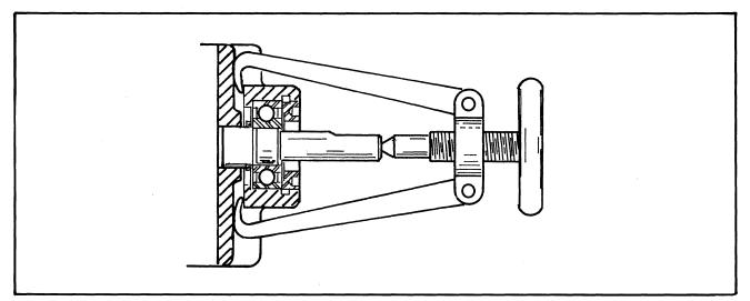
FIGURE 5-4 GEAR PULLER PLACEMENT
