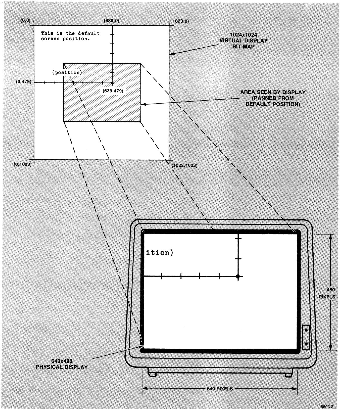
Figure 1-2. 640 X 480 Window Into 1024 X 1024 Bit-Map.
