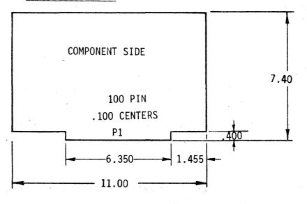
FIGURE 6-14 16K DYNAMIC RAM ENVIRONMENTAL, POWER AND PHYSICAL REQUIREMENTS
