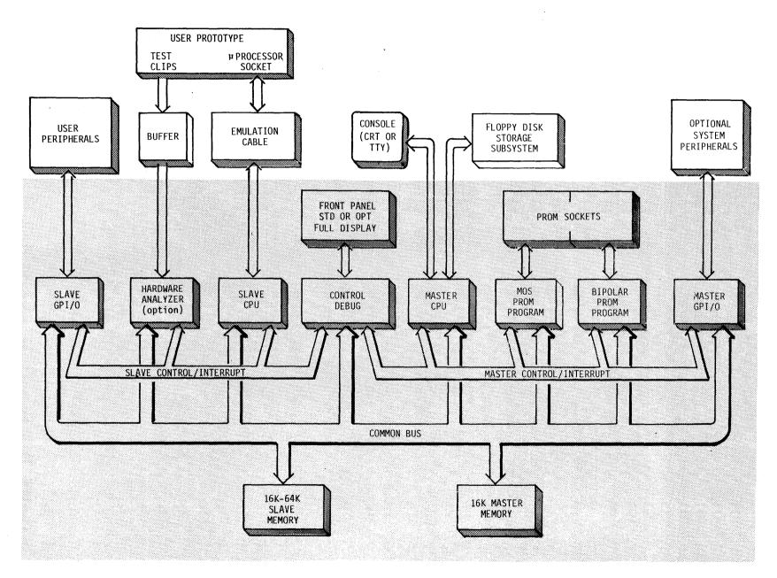
FIGURE 2-1 UNIVERSAL ONE SYSTEM BLOCK DIAGRAM
