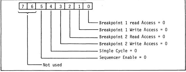
FIGURE 4-8c DEBUG CONTROL BYTE FORMAT
