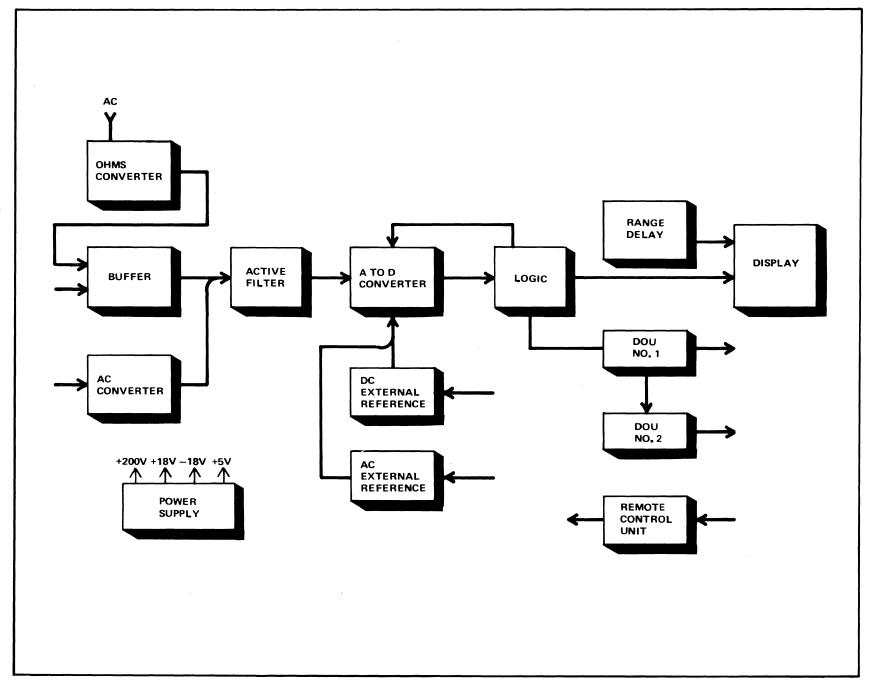
FIGURE 1. MODEL 8400A BLOCK DIAGRAM
