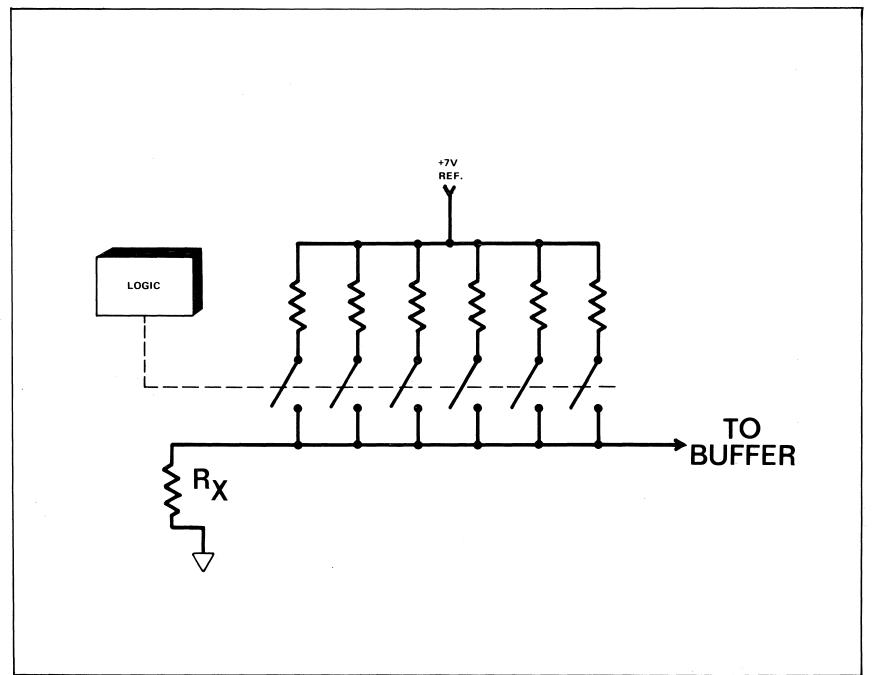
Figure 9.  $\Omega$  CONVERTER -03
