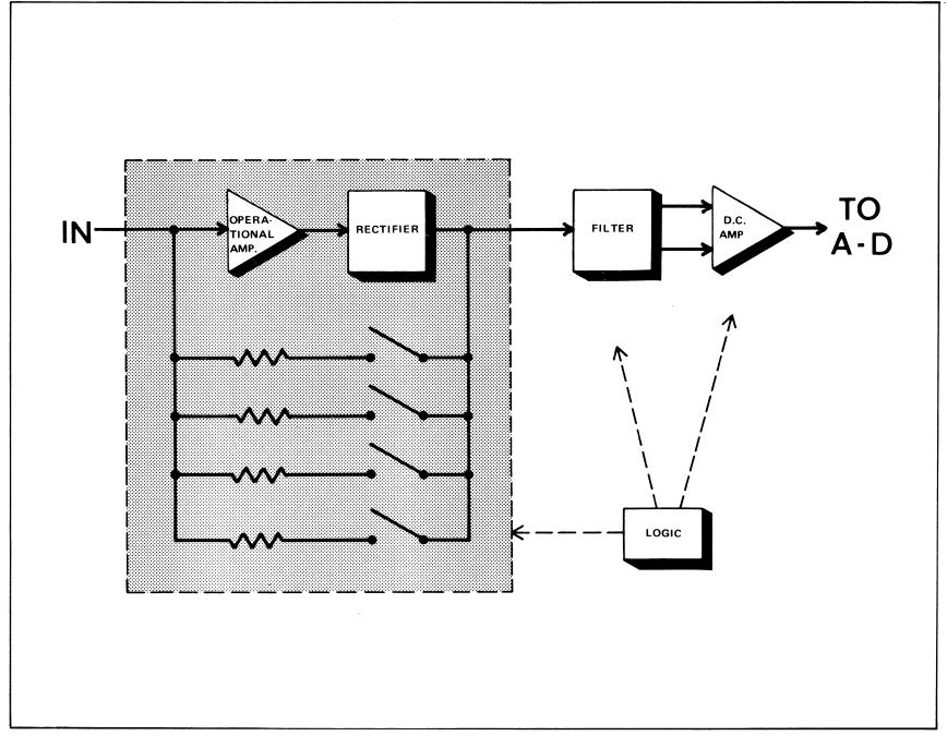
Figure 7. AC CONVERTER --01
